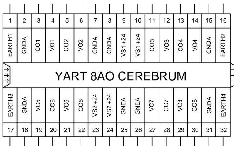
Рисунок 4 – Функциональная схема модуля расширения
