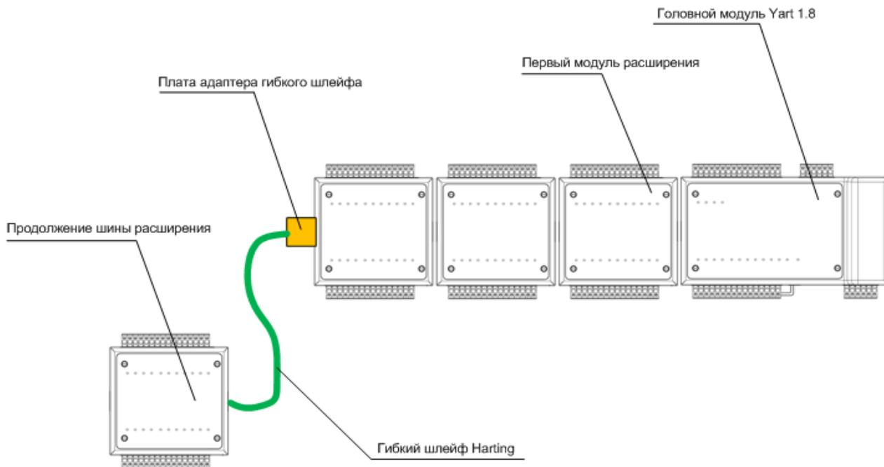
Рисунок 2 – Подключение модулей расширения к контроллеру
