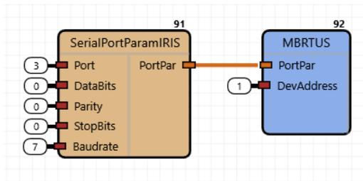
**Рисунок 23. Настройка параметров Modbus RTU Slave**
