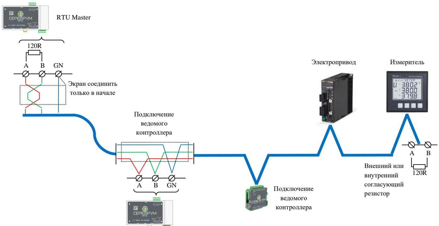
**Рисунок 24. Подключение к шине Modbus RTU**
