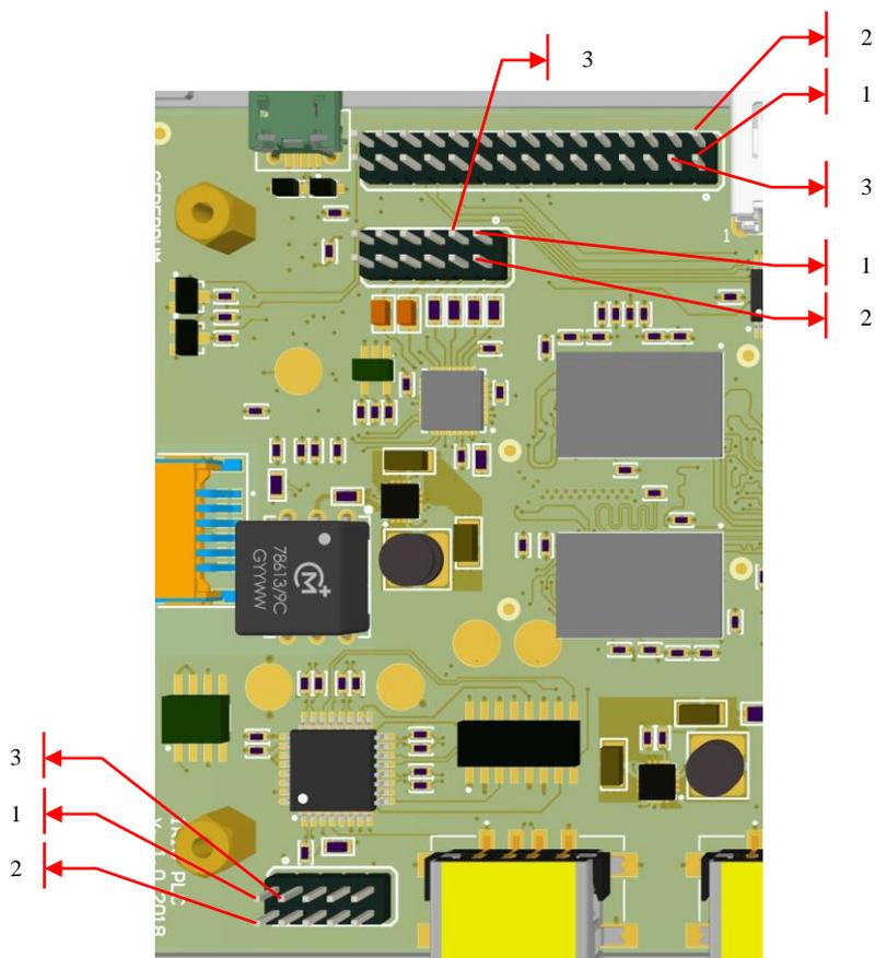
Рисунок 3. Нумерация контактов разъемов расширения
