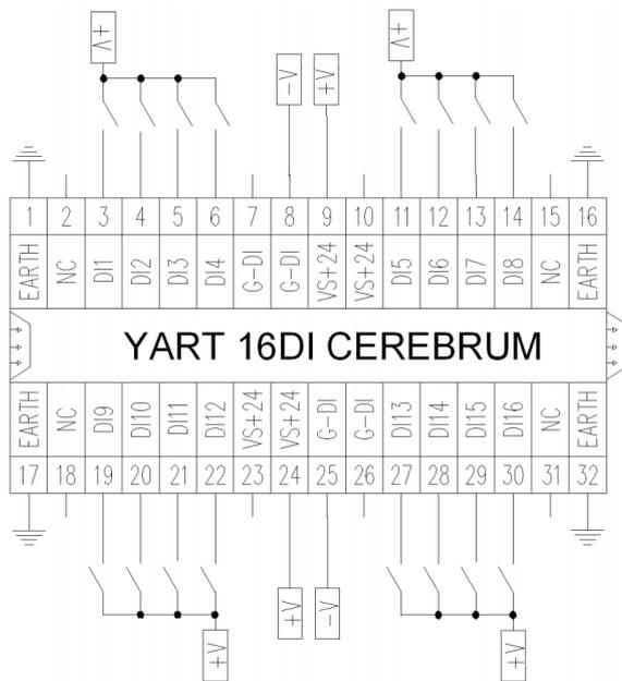
Рисунок 37. Модуль 16DI
