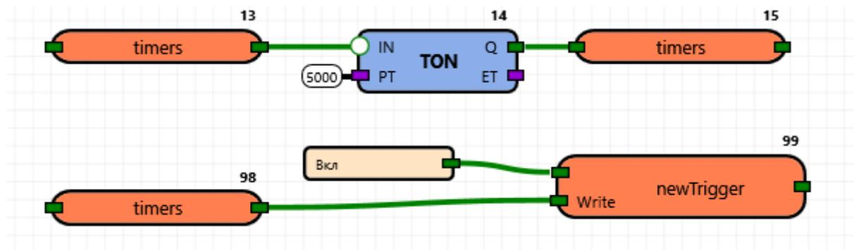
Рисунок 16. Отправка данных на сервер каждые 5 секунд
