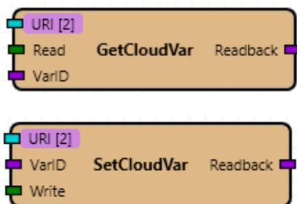
**Рисунок 30. Блоки обмена с сервером телеметрии.**
