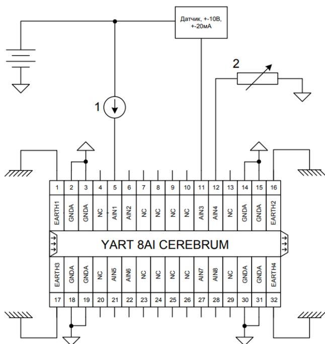
**Рисунок 32. Модуль 8AI**
