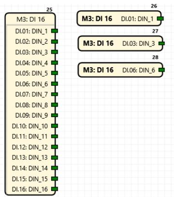
Рисунок 38. Блоки дискретного ввода
