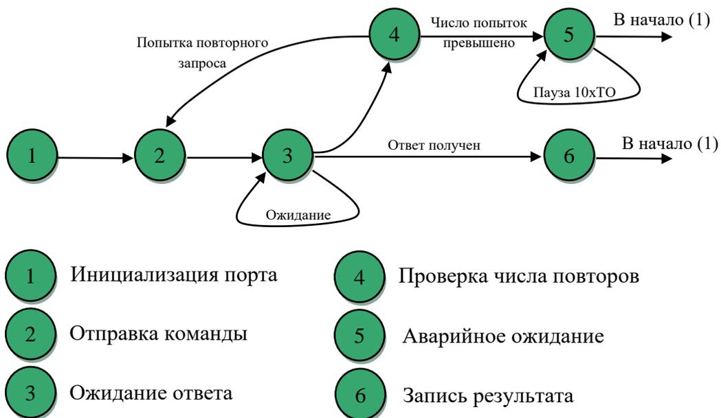
Рисунок 26. Работа слотов и диаграмма состояний коммуникационного слота.
