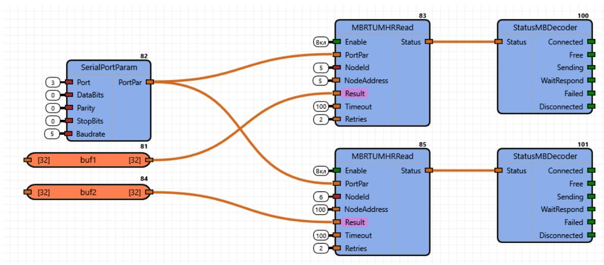
**Рисунок 25. Конфигурация обмена Modbus RTU Master**
