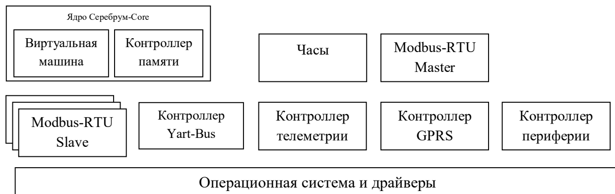
Рисунок 9. Архитектура контроллера COBALT
